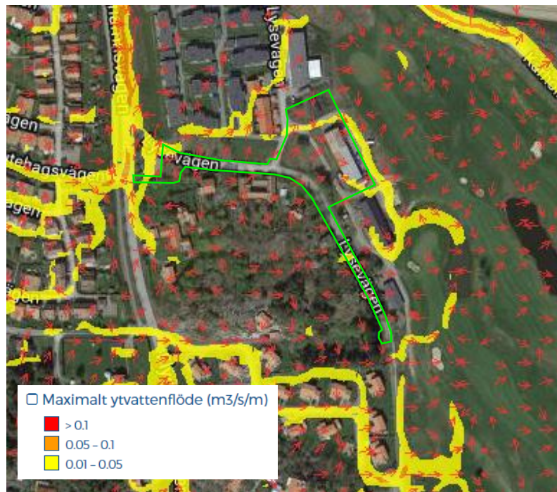
Figur 13. Ytvattenflöde och flödesriktning vid klimatanpassat 100-årsregn. Utdrag ur skyfallsmodellen. Planområdet markerat med grön linje.
